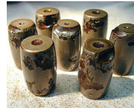
Valjčici nedovoljnog kvaliteta u falsifikovanom bačvastom ležaju
